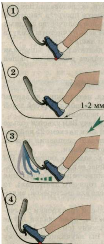
Рис. 27. Положения левой ноги при нажатии педали сцепления: 1 - «пятка стоит»; 2 - «пятка приподнялась»; 3 - «пятка скользит»; 4 - «пятка стоит»
